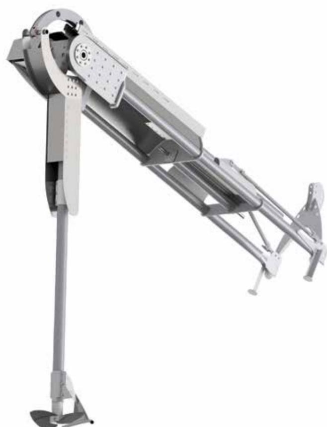
Grâce à un système cinématique unique en son genre, il est possible de pivoter l'engin jusqu'à 170°, commande à partir de la cabine du tracteur.
