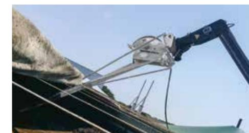
Le bras télescopique ou le support du chargeur frontal (disponible pour différents modèles) permet d'utiliser le mixer électrique dans des fosses à lisier ouvertes, des digesteurs ou des installations de biogaz.
