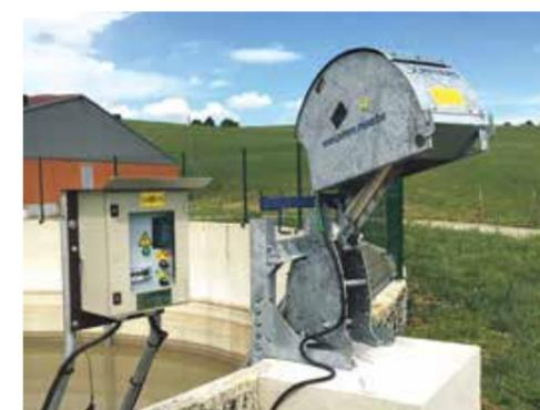
Installé sur le bord du mur de fosse, le mixer électrique SLE assure toute l'année un mélange régulier du lisier dans la fosse ouverte. Il peut être équipé d'un dispositif de réglage de la hauteur hydraulique ou manuel.
